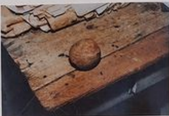
Die Salpetermühle am Teich des Neuerhammers wurde von einem Wasserrad angetrieben (unten). Im Obergeschoss waren große Trommeln montiert, die mit Pockholzkugeln gefüllt waren (oben). Im Untergeschoss befand sich neben dem Mahltrichter noch ein Schüttelwerk (Mitte).
